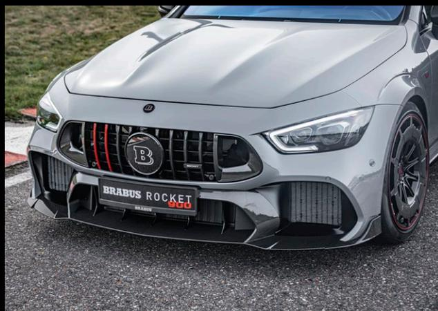
Um dem neuen BRABUS Supercar seinen extravaganten BRABUS-Bold-Look zu verleihen, haben wir einen aggressiv gestylten ROCKET 900 Widebody für das viertürige Coupé entwickelt. Dieser ist genau wie das Front-Design, Heckflügel und Diffusor aus hochfestem, leichtem Carbon gefertigt. Sie erzeugen mehr Abtrieb und erhöhen damit die Fahrstabilität bei hohen Geschwindigkeiten.
